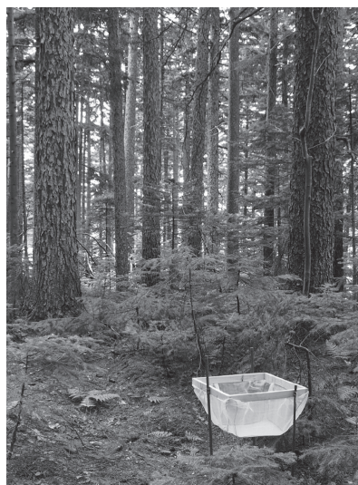
図 2 アカエゾマツ林に設置された花粉生産量測定のためのリタートラップ。
