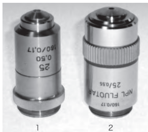
図4 対物レンズ。— 1: Lomo 25×/0.50, 2: Leitz NPL Fluotar 25×/0.55.
