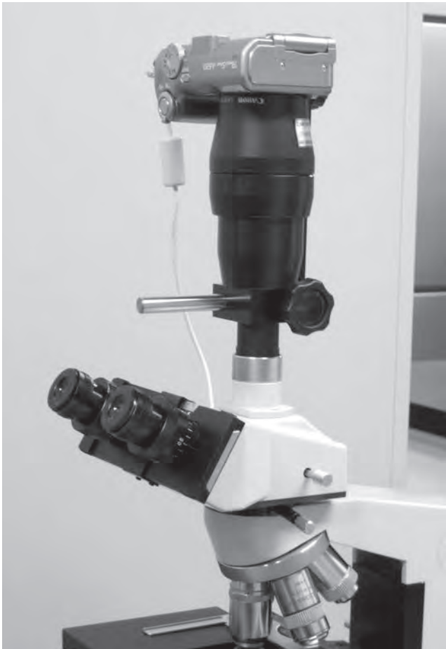
図 7 コンパクトデジカメ (Canon A620) を利用した撮影装置の例。
