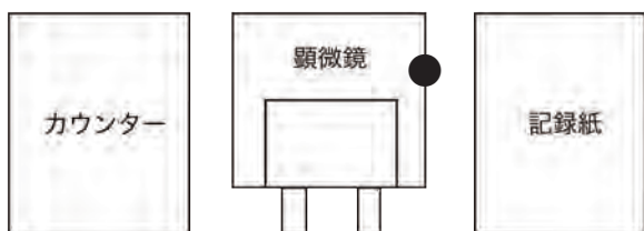
図6 右利きの場合の顕微鏡、計数機、記録紙の配置例 (●はステージ送りハンドルの位置)。
