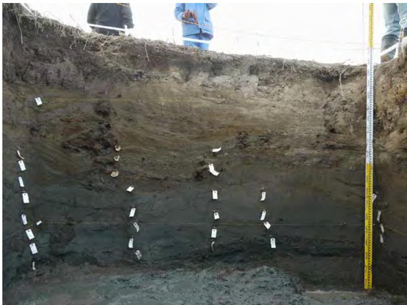
写真5 トレンチの断面。最下部の青灰色粘土は中部更新統の上岩橋層である。その上位に、上部更新統の緩斜面堆積物が厚さ約1.6 mで不整合に覆う。この堆積物は、斜交葉理が発達した礫質の中～粗粒砂やシルトからなる河川性堆積物の特徴があり、上方細粒化の傾向がみられる。撮影：安藤寿男。
