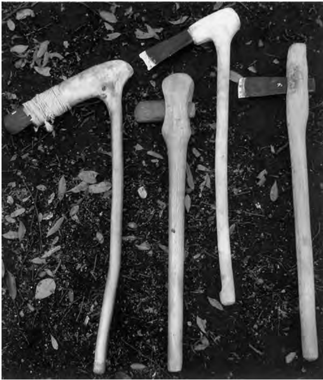
図2 実験に使用した磨製石斧と鉄斧。 Fig. 2 Stone axes and iron axes used in the experiment.
